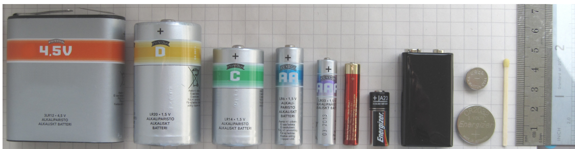
FIGURE 81 – Différents types de batterie : 4,5 V ; batterie D ; cellule C ; cellule AA ; cellule AAA, cellule AAAA ; cellule A23 ; batterie 9 V ; pile bouton (CR2032) ; pile bouton (LR44) [Wikipedia, nd]
