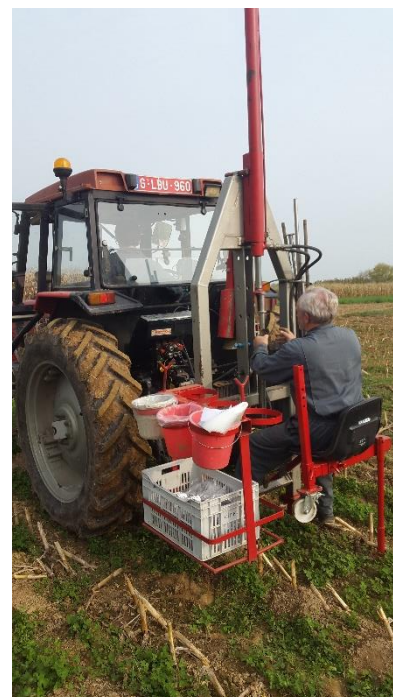
Figure 14 : Carotteuse hydraulique qui a servi à prélever les échantillons de sol
