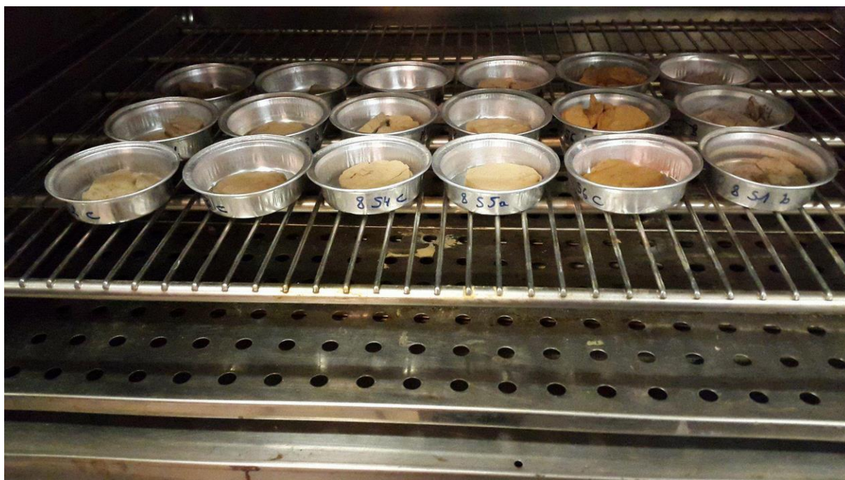
Figure 8 : Echantillons de sol en train de chauffés dans l'étuve
