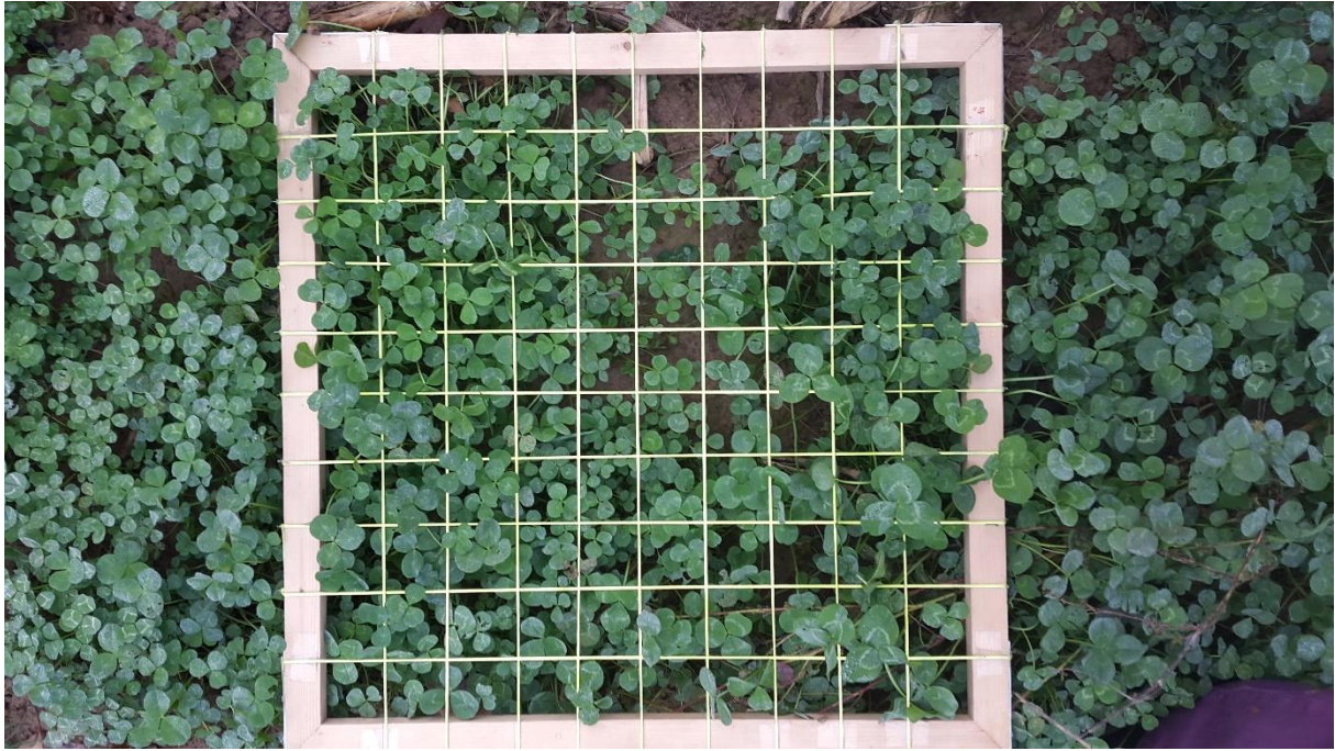
Figure 5 : Cadre servant à la mesure de la surface foliaire effective
