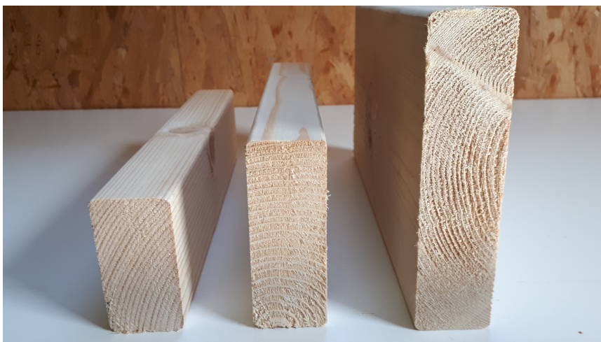
FIGURE 5.15 – Dans l'ordre : pièce débitée sur dosse, sur quartier et sur faux-quartier
