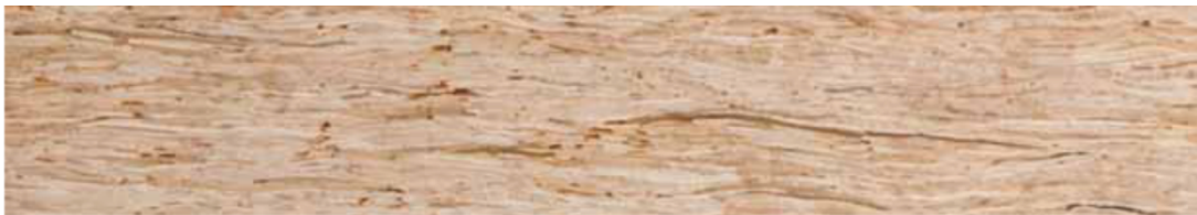
FIGURE 2.14 – Profil du bois de longs copeaux laminés (LSL)
