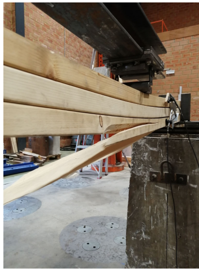
FIGURE 5.26 – Rupture par traction perpendiculaire aux fibres
