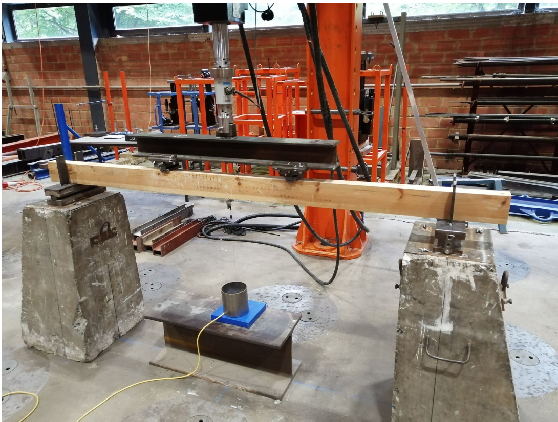
FIGURE 5.28 – Montage poutre en bois massif en flexion 4 points
