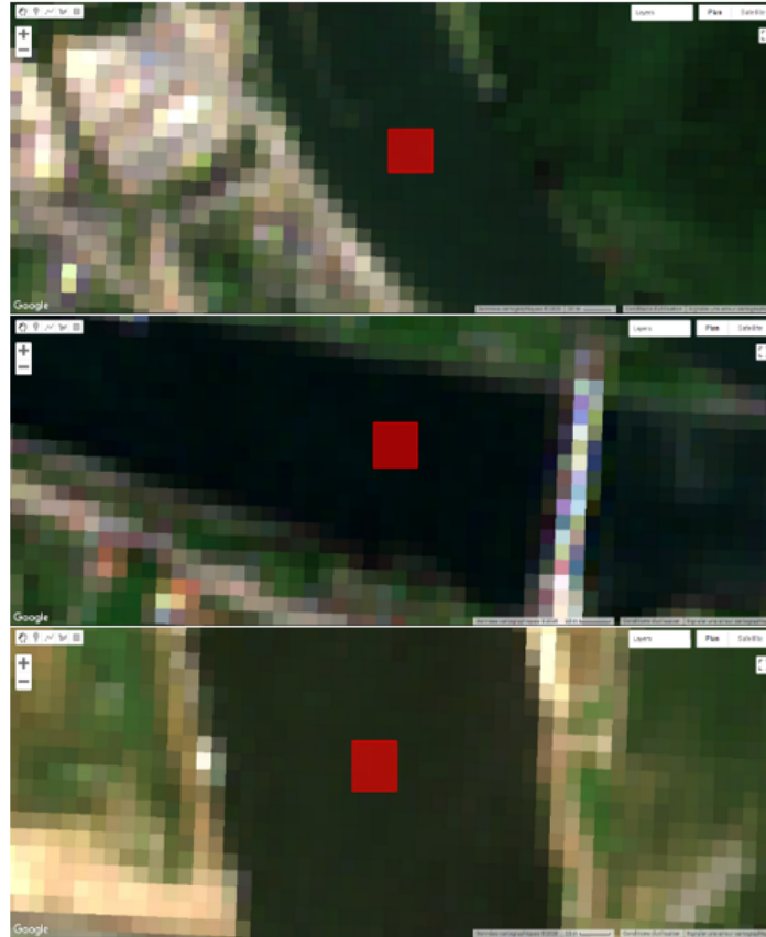
FIGURE 12 – Zones de sélection de la fenêtre de 3x3 pixels représentées sur les images Sentinel-2 niveau 2A disponibles sur GEE, de haut en bas : Hastière, Andenne, Lixhe.
