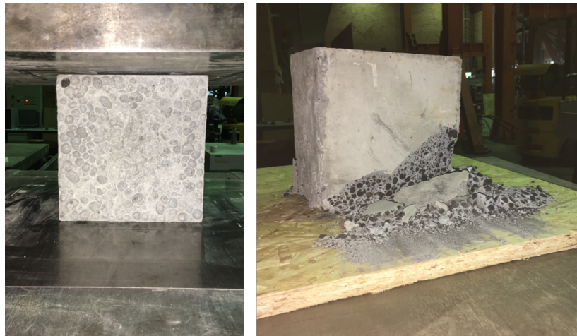
FIGURE 4.11 – Dispositif d'essai des cubes de béton
