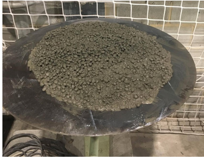
FIGURE 4.14 – Résultat de l'essai d'étalement à la table à choc
