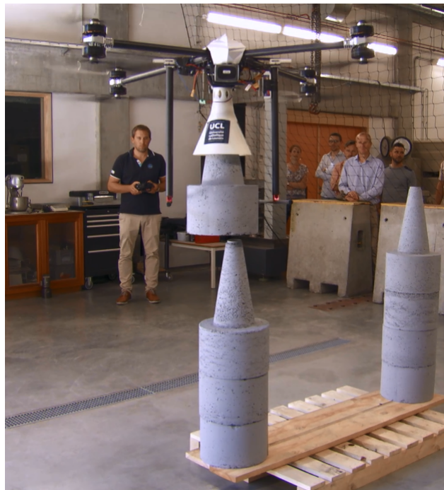
FIGURE 3 – Structure drone-compatible composée de colonnes
