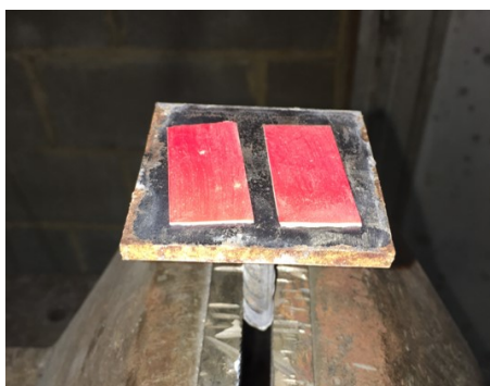
FIGURE 4.7 – Plat métallique équipé de pâte collante destiné à être collé au moule
