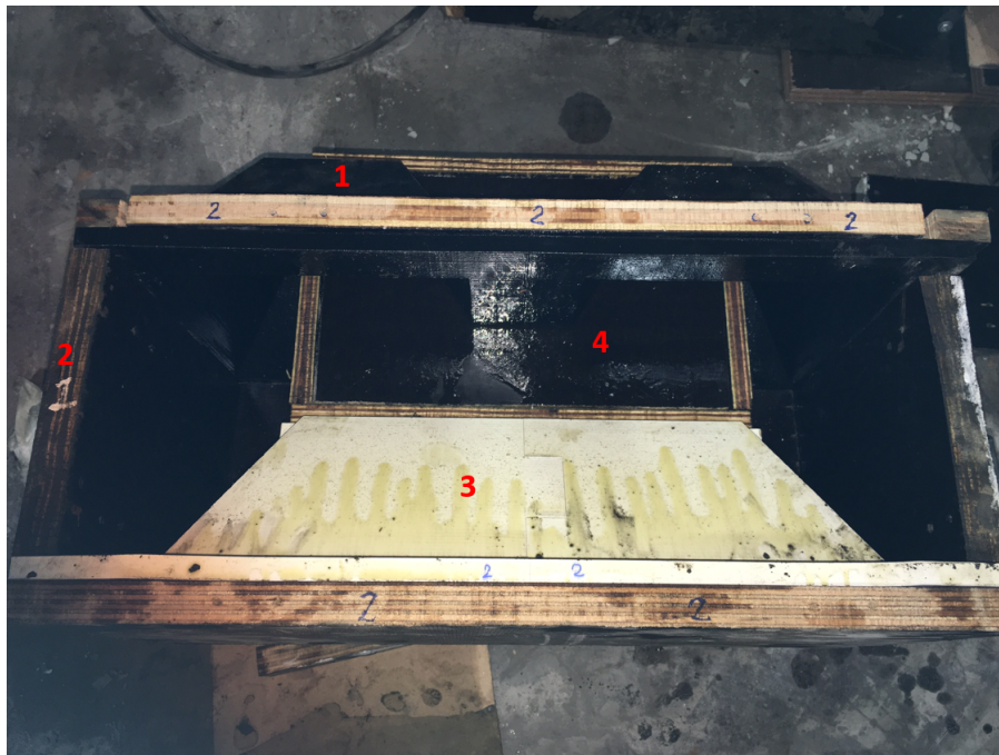
FIGURE 4.4 – Moule utilisé pour réaliser les Dricks LP
