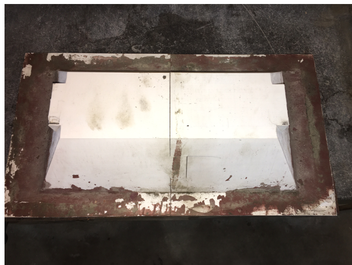
FIGURE 4.9 – Moule dont les pentes étaient initialement couvertes de silicone
