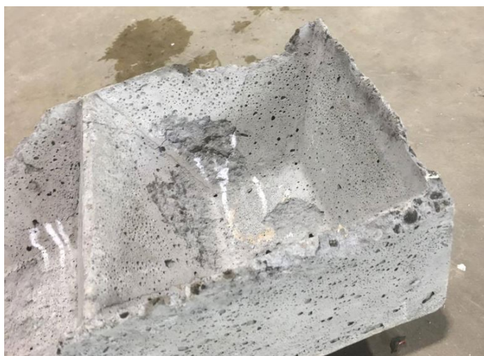
FIGURE 1.8 – Illustration du problème des arêtes d'épaisseur nulle
