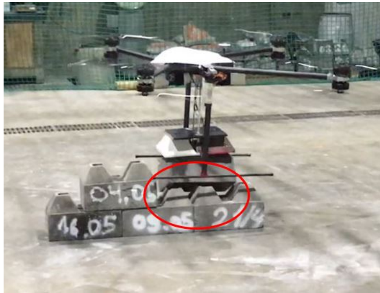
FIGURE 6.5 – Dépose manuelle du bloc en dehors de la zone de reprise des imprécisions
