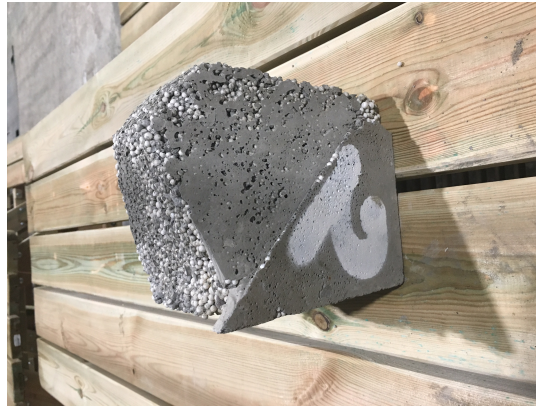
FIGURE 4.2 – État de surface insuffisant dû aux billes de polystyrène qui remontent à la surface.
