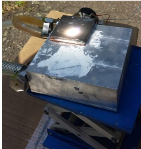
Figure 42 – De bas en haut : Récepteur et module thermoélectrique, boîte à eau et statif de chimie réglable
