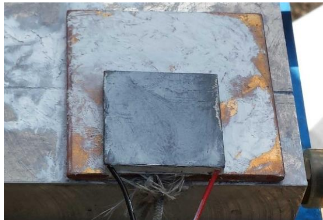
Figure 41 - Générateur thermoélectrique et plaque de cuivre enduit de pâte thermique
