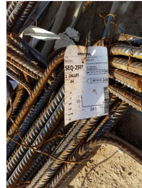
FIGURE 24 – Etiquette d'identification de lot d'armatures
