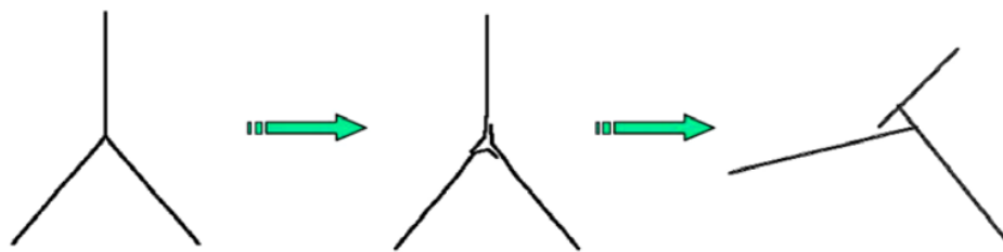
Figure 34 - Transformation de trois éléments en module réciproque grâce à la relaxation dynamique [4]
