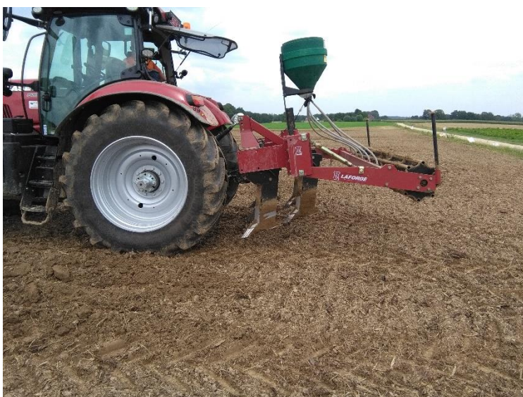
Figure 5c : Matériel de strip-till utilisé pour le semis des couverts dans les futures lignes de la betterave.
