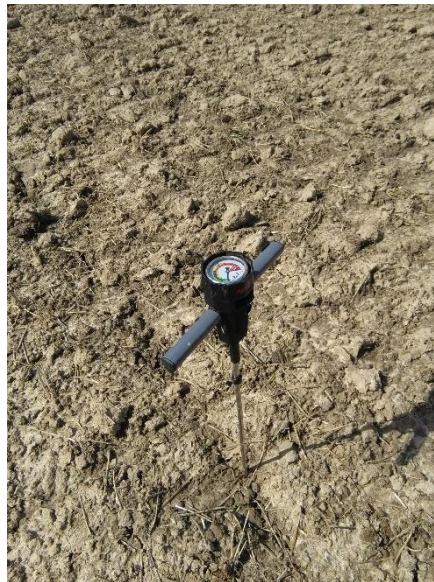
Figure 9 : pénétromètre utilisé pour évaluer la compaction du sol.
