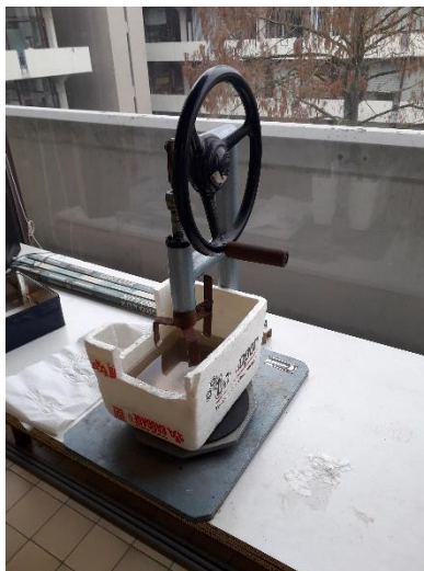
Figure 7 : Appareil de Féodoroff utilisé pour évaluer la stabilité structurale des sols.
