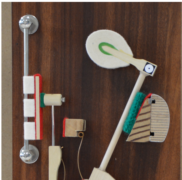
FIGURE 2.16 – Photo de la barre remplaçant la corde dans la mécanique de test
