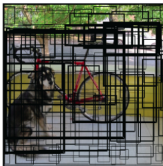
FIGURE 2.4 – Illustration de la détection et de la localisation des objets par YOLO. [3]
