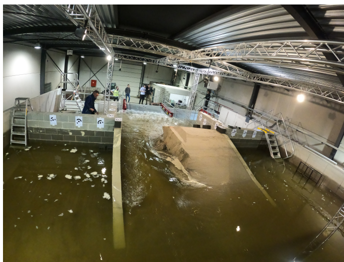
FIGURE 5.5 – Etat de la digue après 28 minutes.
