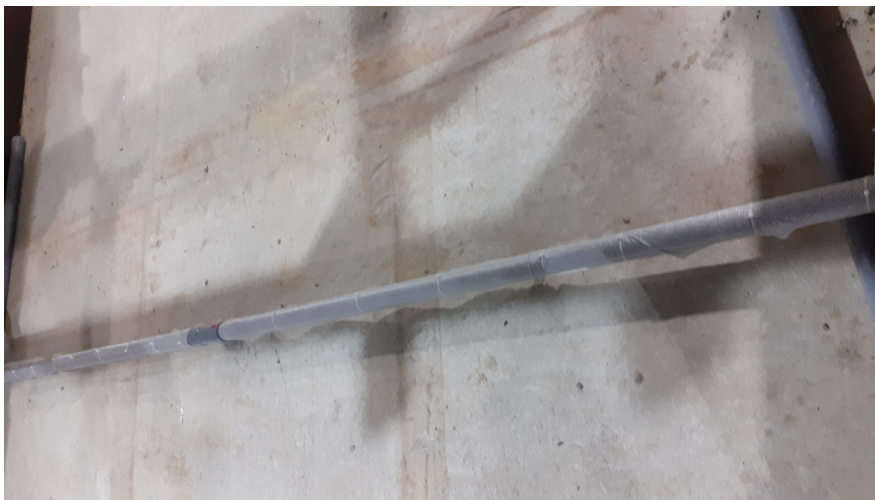
FIGURE 4.11 – Drain recouvert d'un géotextile.
