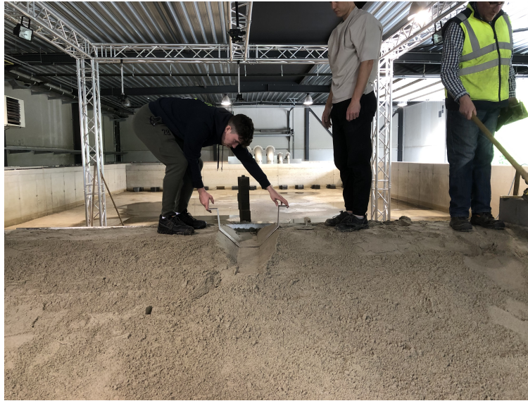
FIGURE 4.17 – Formation de la brèche à l'aide d'un gabarit.
