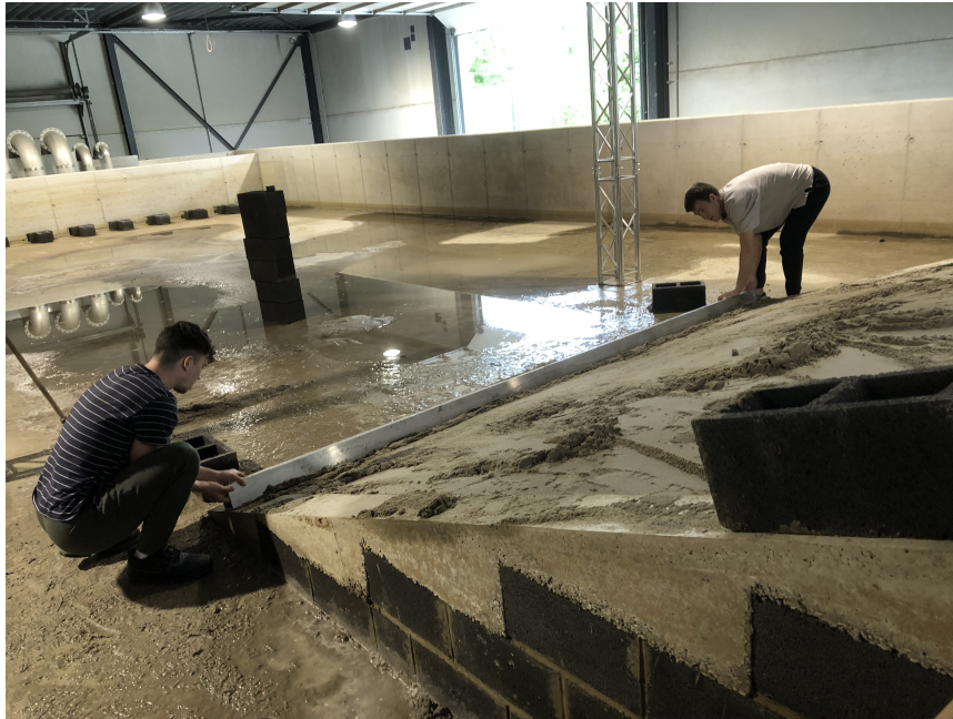
FIGURE 4.16 – Tirer le sable à l'aide d'une règle de maçon.
