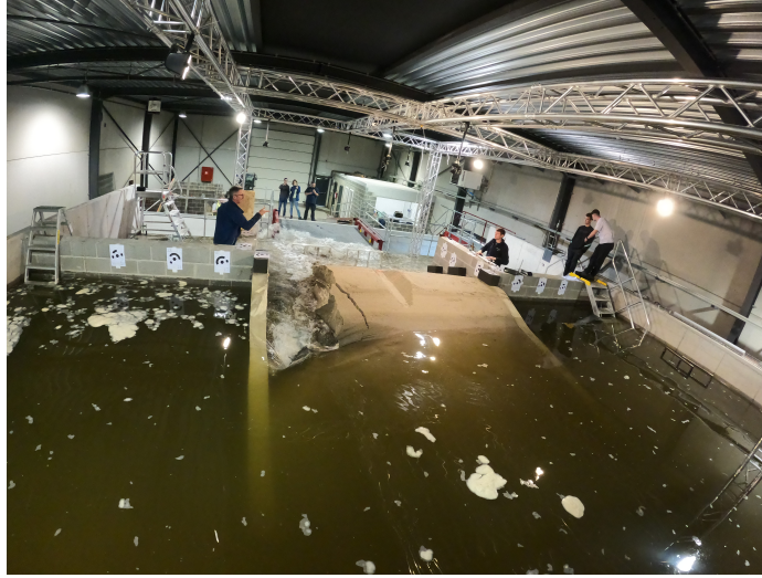
FIGURE 5.6 – Effondrement par bloc cohésif.
