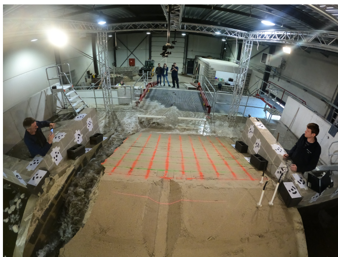
FIGURE 5.4 – Segment de 60 [cm] de digue emporté par l'eau.
