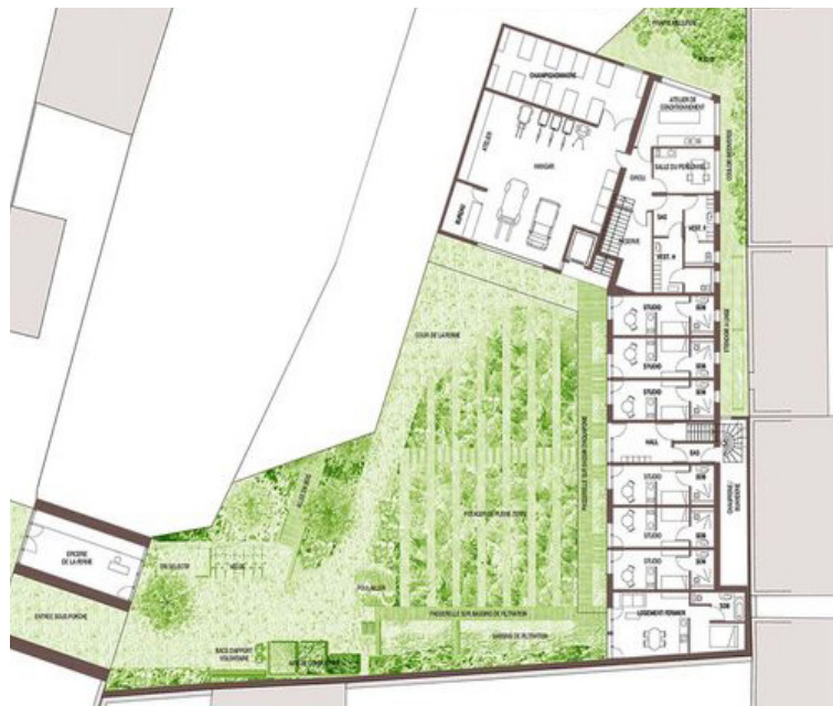
Fig-29 Plan rez-de-chaussée, la ferme du rail.
