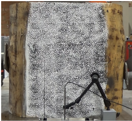
Figure 5.24 – Photo de l'échantillon quelques secondes avant le pic de force
