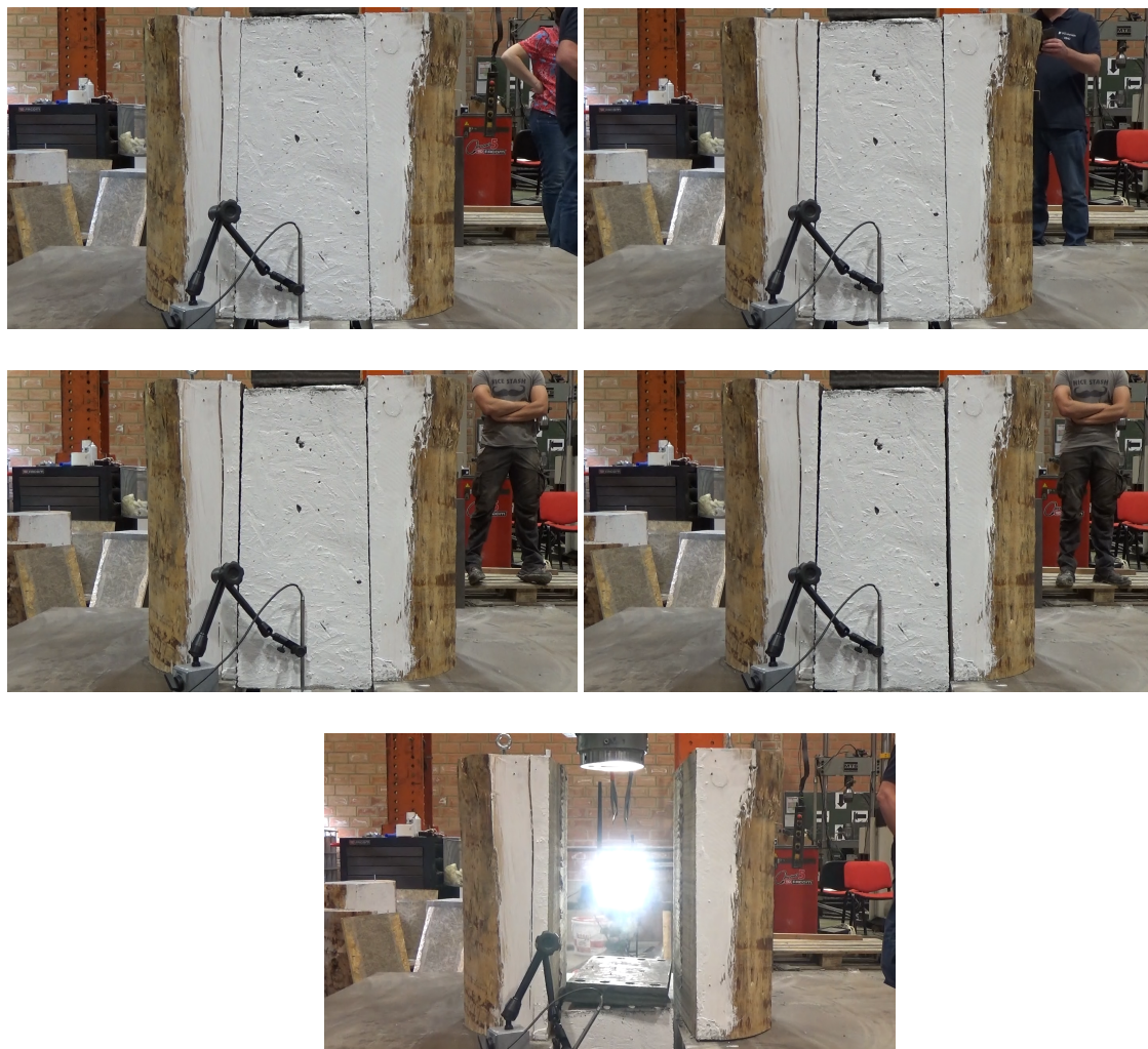
Figure 5.30 – Evolution des déformations de l'échantillon pendant le test de cisaillement
