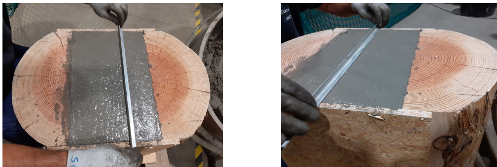
Figure 5.11 – Photos du lissage manuel réalisé par un technicien du LEMSC
