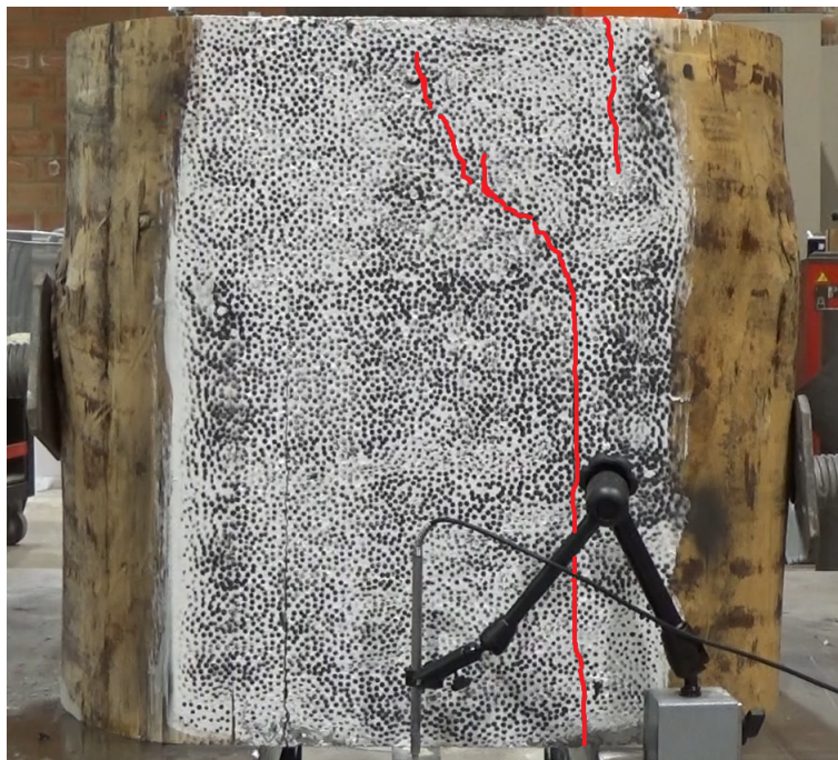
Figure 5.26 – Photo du test juste après le pic avec les fissures mises en évidence en rouge
