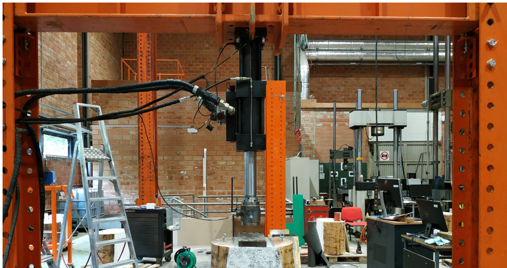
Figure 5.14 – Vérin hydraulique fixé au portique
