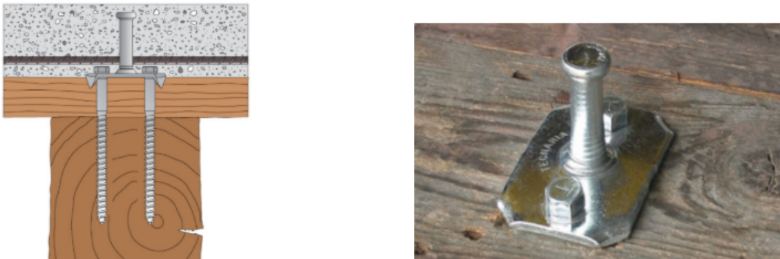
Figure 2.11 – Connecteur Tecnaria
