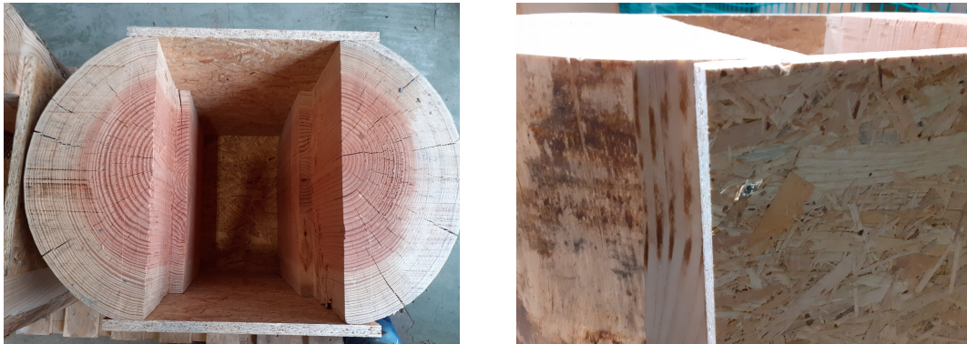
Figure 5.10 – Photos d'un échantillon avant coulage du béton
