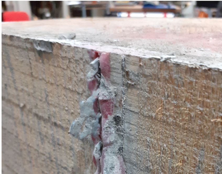
Figure 5.34 – Image de la tôle étant restée dans le bois après la rupture
