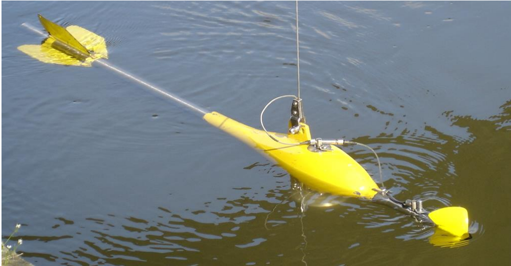
Figure 10 : Saumon équipé d'un courantomètre
