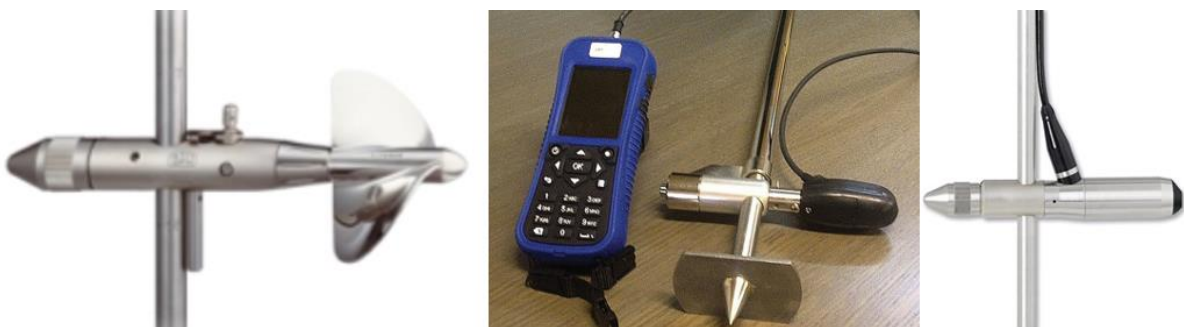
Figure 9 : De gauche à droite, un courantomètre à hélice, électromagnétique et acoustique
