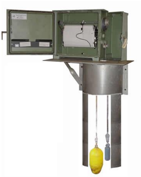
Figure 2 : Limnigraphe OTT à flotteur
