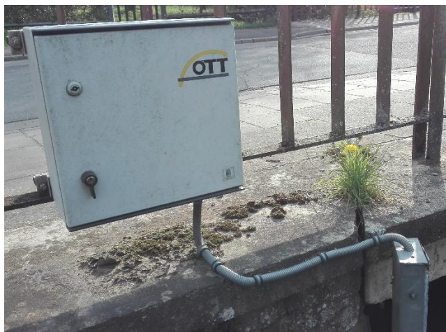
Figure 3: Station L6440 – Ton à Virton - Boîtier et échelle limnimétrique comprenant le capteur
