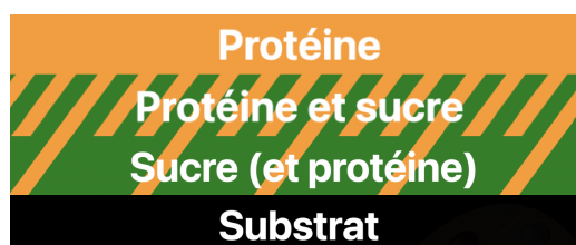
FIGURE 5.16 – Schéma de la couche formée par le transfert de bradykinine (protéine) sur tréhalose (sucre) sublimé sur silicium (substrat). Les proportions montrées sont à titre indicatif.
