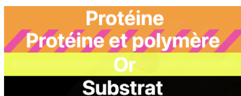
FIGURE 5.33 – Schéma de la couche formée par le transfert de bradykinine (protéine) sur couche de PEG (polymère) construite sur silicium recouvert d'or (substrat). Les proportions montrées sont à titre indicatif.
