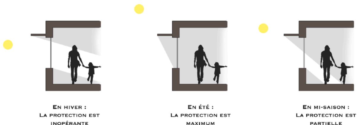
Figure 8 : Illustration de l'ombrage créé par un brise solaire fixe en fonction des saisons. (espace orienté au sud), Zachary ADJOU.
