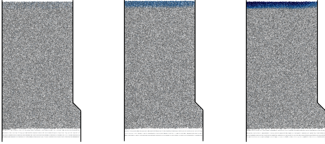
FIGURE 4.7 – Représentation du poids des grains à t = 40 [s], t = 41 [s] et t = 41.5 [s] (de gauche à droite) (Plus les grains sont lourds, plus ils sont bleu foncé)
