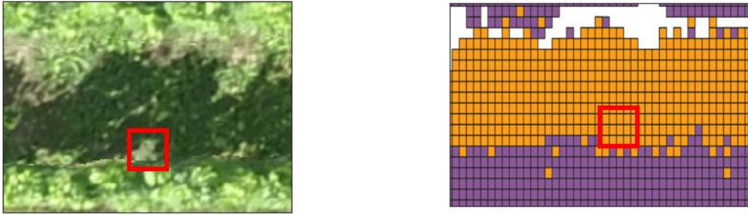
Figure 22 : Illustration de la limite de la modélisation de l'ombre dans la détection des trous dans la canopée.
