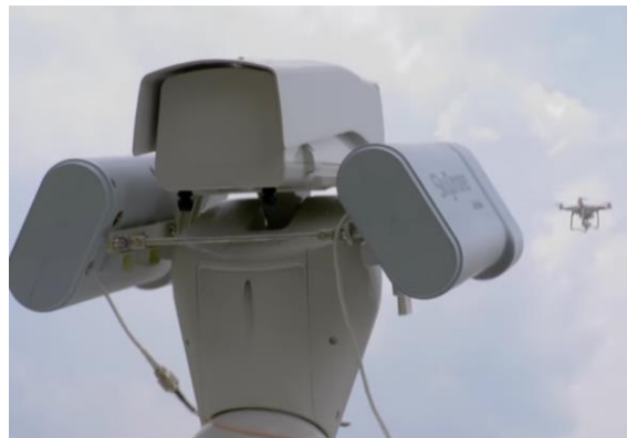
Figure II-11 – Caméra qui détecte et contrôle des drones (CNBC International, 13 octobre 2017)
