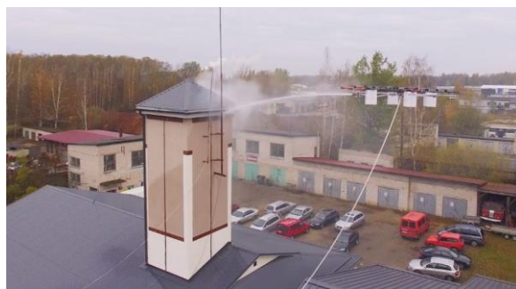
Figure II-2 – Drones-pompier arrosant une cible d'entraînement (Mr.Geek, 7 avril 2018)
