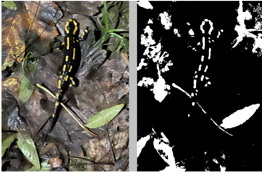
FIGURE 5.1 – K-Means appliqué sur une image du dataset de LLN (CIELAB, n = 2 , c = [1, 2] )
