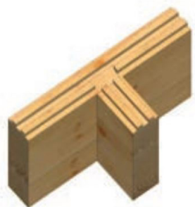
ill 2.65: Assemblage à queue d'aronde pour madrier.
