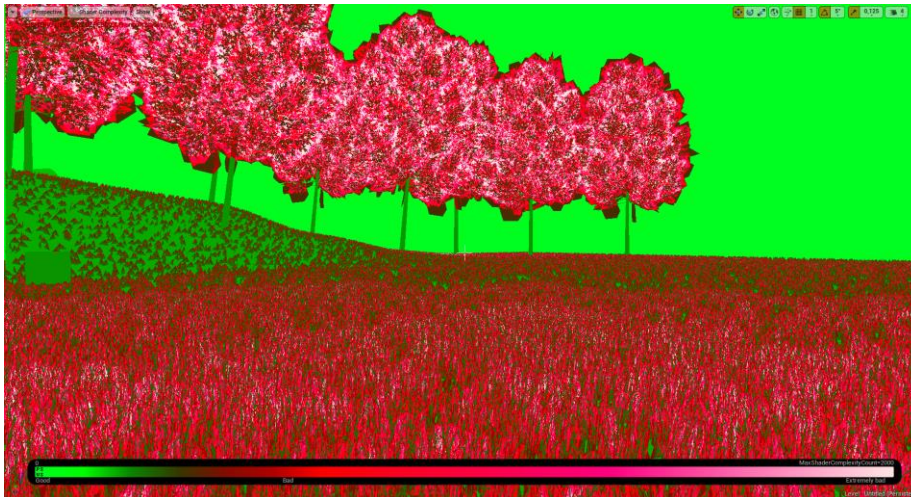
Figure 8 - Exemple d'interface présentant la shader complexity d'une scène 1
