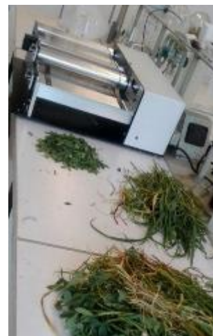
Figure 11 : Scanneur LI-3100c Area Meter de la société LI-COR utilisé pour mesurer la surface verte.
