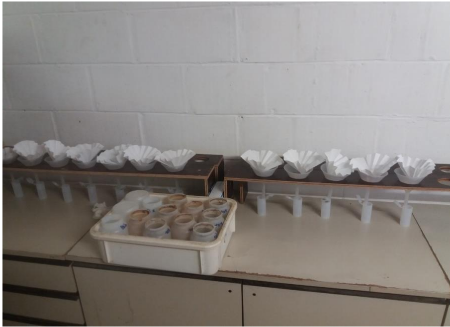
Photo 6 : filtration des échantillons après extraction des nitrates pour récupérer des filtrats contenant les nitrates (Photo : Martin Charles)
