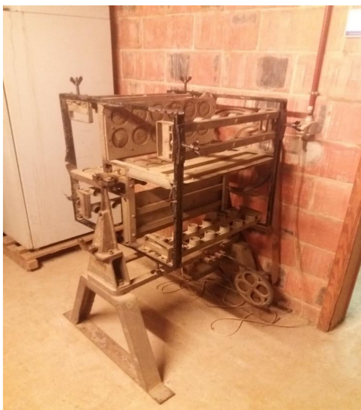
Photo 5 : appareillage utilisé pour l'agitation des échantillons permettant d'en extraire les nitrates à l'aide d'une solution de KCL (Photo : Martin Charles)
