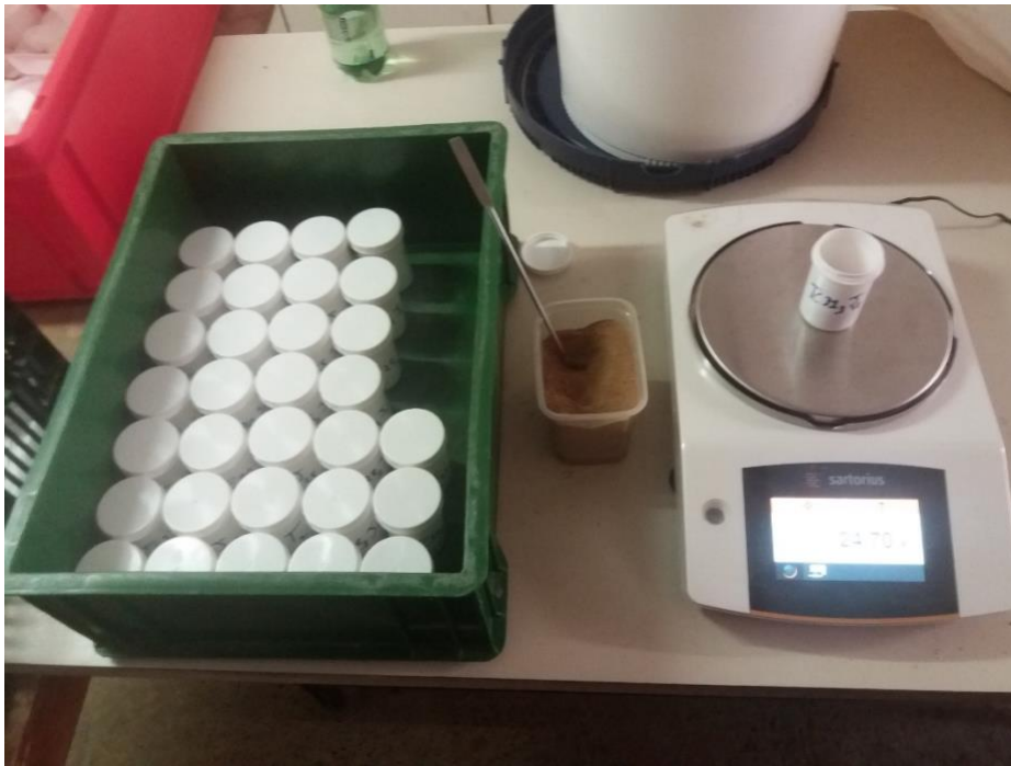
Photo 3 : pesée et préparation des échantillons rassemblés dans un grand contenant à destination de l'étuve (Photo : Martin Charles)
