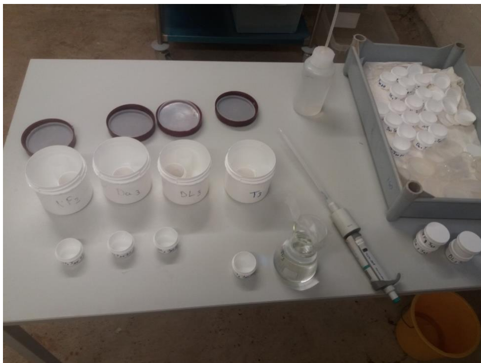
Photo 1 : montage expérimental pour la minéralisation du carbone organique et le piégeage du CO_2 dans une solution alcaline (Photo : Martin Charles)
