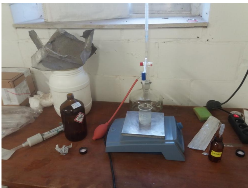
Photo 2 : Appareillage pour le dosage volumétrique du \text{CO}_2 : On titre le NaOH en excès (qui n'a pas précipité sous forme de carbonate) par du HCl (Photo : Martin Charles)
