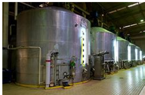
Figure 10 Photo d'un système d'évaporation à multiple effet utilisé en industrie (Raffinerie Tirlemontoise, s.d.)
