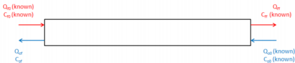
Figure 73 Schéma d'une module membranaire unique. La lettre Q symbolise le flux, C la concentration. Le premier indice symbolise l'alimentation par le f, et l'osmotique par le o. Le second indice réfère à la valeur initiale par 0, et à la valeur finale avec f (Simon, 2016).
