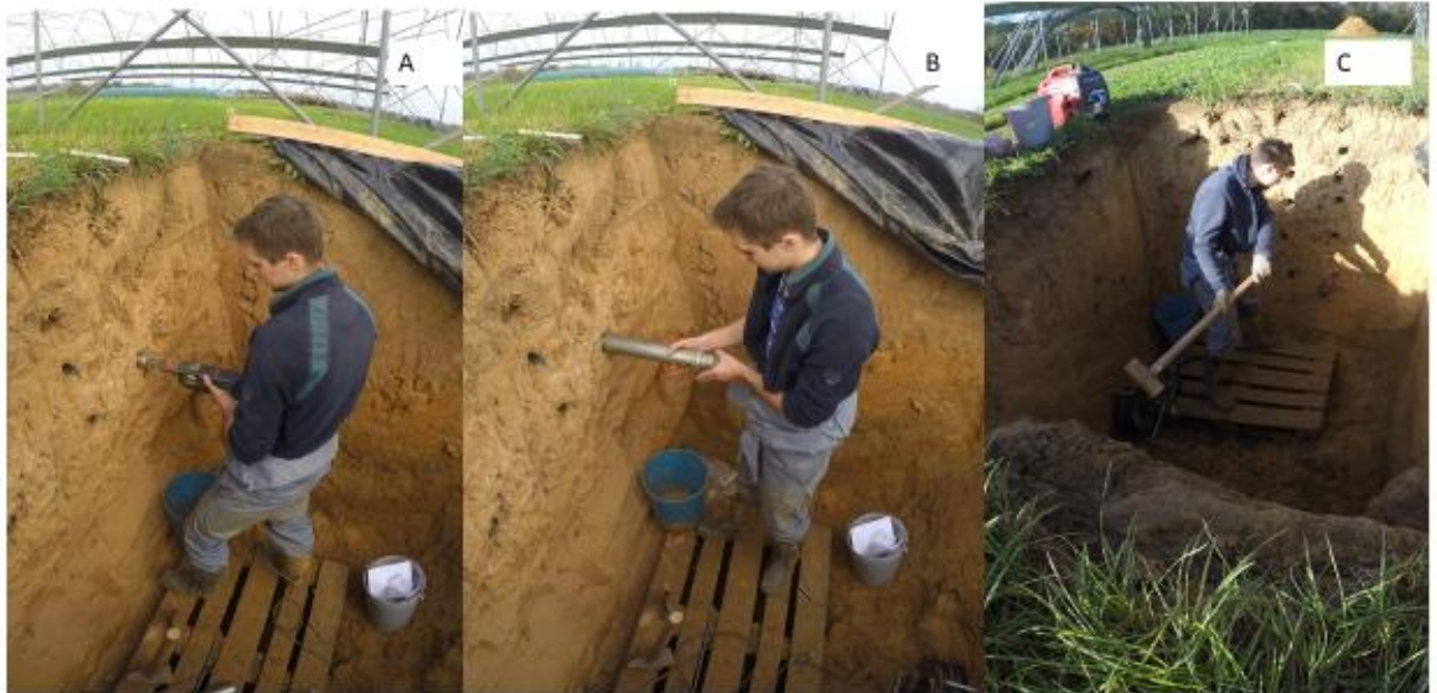
Figure 9: Détail de la méthode utilisée pour réaliser les prélèvements horizontaux. Sur l'image A, le trou est préforé, ensuite, en B, le tube est introduit, et enfin, en C, le tube est enfoncé à coups de masse.
