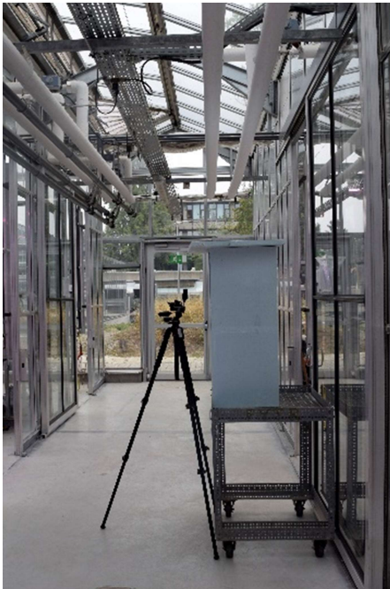
Figure 18 : Vue latérale du dispositif de prises de photos (pied d'appareil + boîte).
