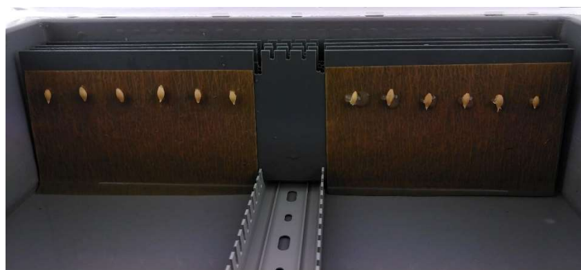
Figure 12 : Vue latérale des plaques de plastique auxquelles sont collés les papiers filtres. Les plaques reposent sur un peigne tandis que le papier filtre touche le fond pour que l'eau puisse remonter par capillarité et hydrater les graines.
