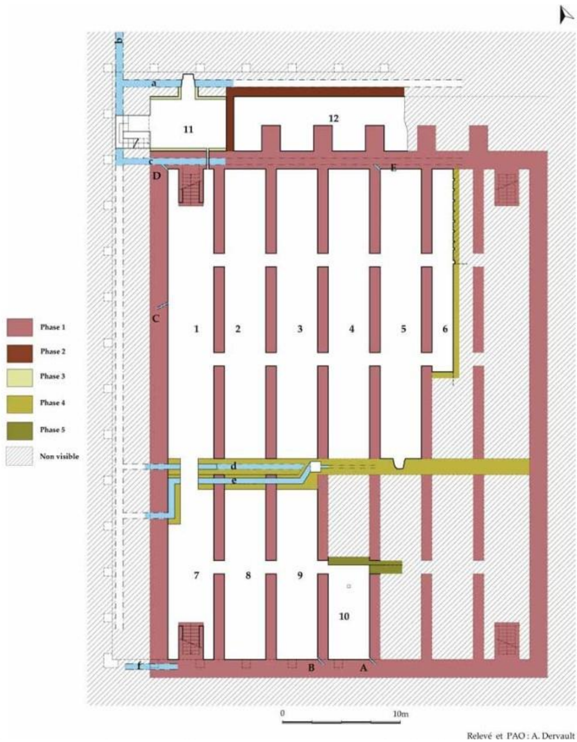
Figure 25. Château d'eau II, IV, 2 sous la palaestre des Thermes de Neptune. Planimétrie schématique, avec indication des principales phases (BUKOWIECKI, DESSALES et DUBOULOZ 2008).
