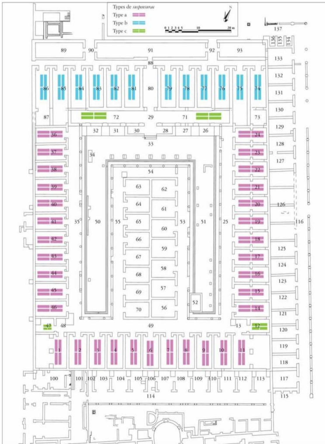
Figure 60. Répartition typologique des suspensurae dans les Grandi Horrea (BUKOWIECKI, MONTEIX et ROUSSE 2008).
