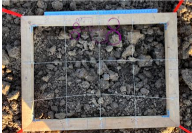
Figure 19 : Exemple d'une placette de battance et des gabarits utilisés pour la détermination du D_{min} via le logiciel GIMP (G.Dehaye)
