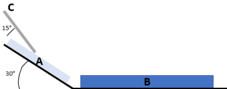
Figure 3.12 – Représentation schématique de l'installation pour un transfert. (A) target sur laquelle se trouve la matrice à transférer disposée sur un plan incliné à 30^\circ (B) échantillon à analyser sur lequel est transféré la matrice (C) faisceau d'Argon venant pulvériser la matrice à un angle de 15^\circ .
