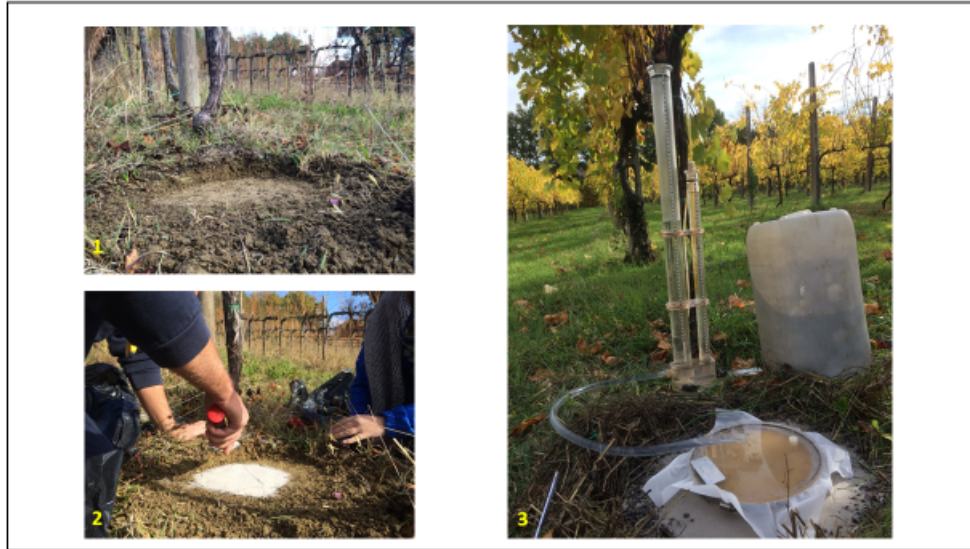
(a) Illustration du dispositif infiltrométrique au champ : (1) nivellement de la surface, (2) installation du lit de sable, (3) dispositif installé pour la mesure.
