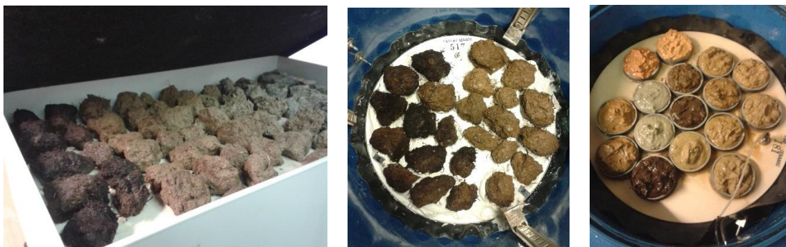
Figure 16: Echantillons de type agrégats lors des mesures de teneur en eau en laboratoire. A gauche et au centre, agrégats non perturbés placés sur une couche de kaolinite respectivement dans le bac à saturation et dans la casserole à basse pression, à droite agrégats sous forme de boue (i.e. perturbés) dans la casserole à haute pression.
