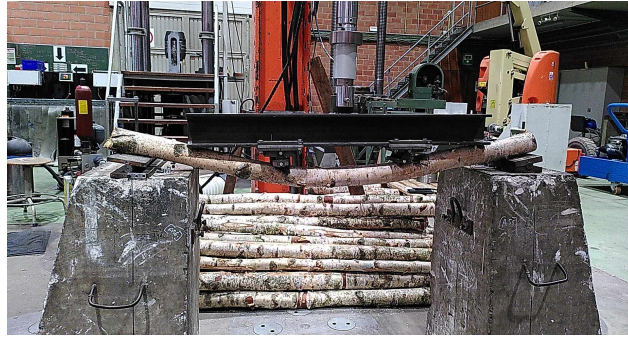
FIGURE 6.2 – Essai de résistance en flexion du bouleau subissant une flexion trop importante pour le dispositif - Essai 4.
