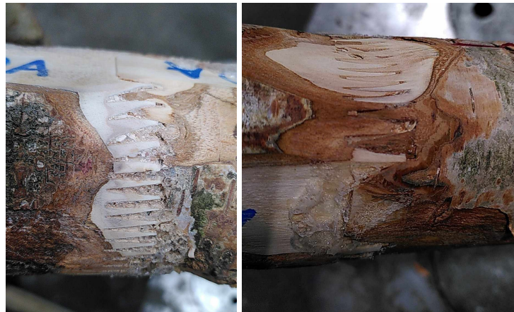
FIGURE 8.14 – Aboutage des essais 10 (gauche) et 17 (droite) après la rupture et ponçage.
