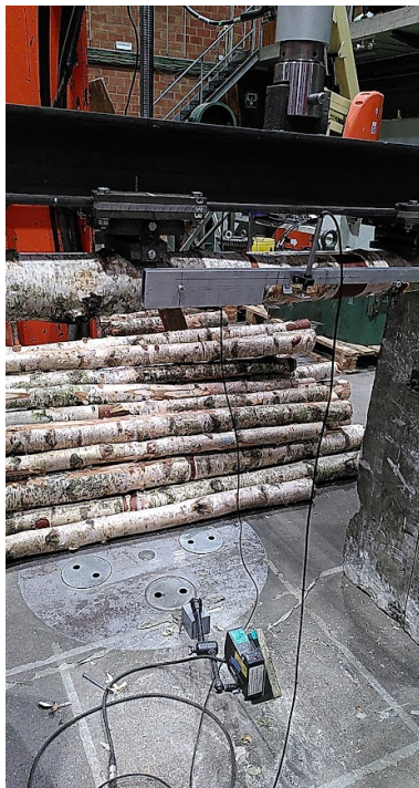
FIGURE 7.7 – Placement du laser pour la mesure de la flèche.
