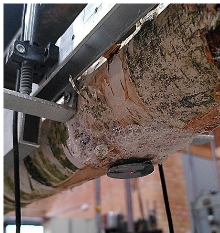
FIGURE 10.7 – Plaquette métallique collée sur les grumes reconstituées pour s'assurer d'une bonne mesure de la flèche globale avec le laser.
