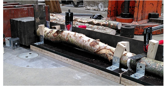
FIGURE 8.7 – Déformations lors du pressage de l'essai 14.
