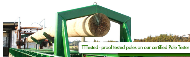
FIGURE 4.1 – Proof-testing d'une grume dans l'entreprise TTTproducts en Nouvelle-Zélande.
