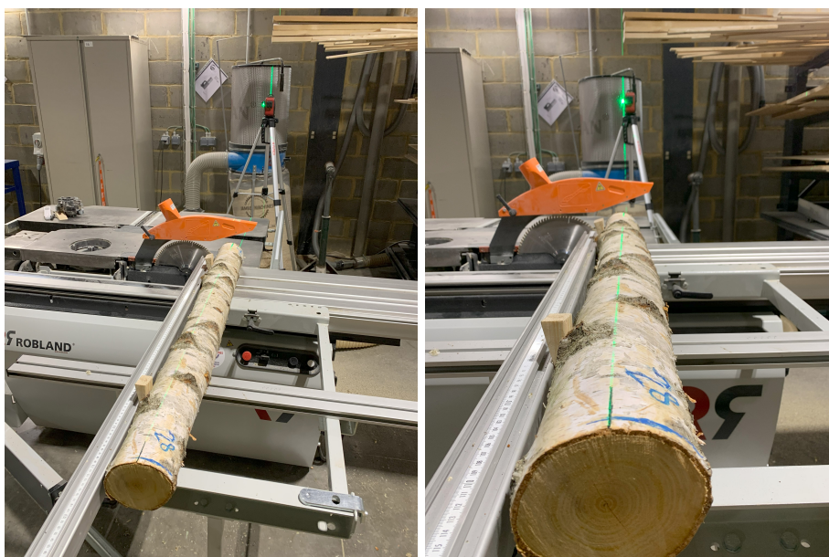
FIGURE 10.1 – Alignement du laser lors de l'usinage des entures.
