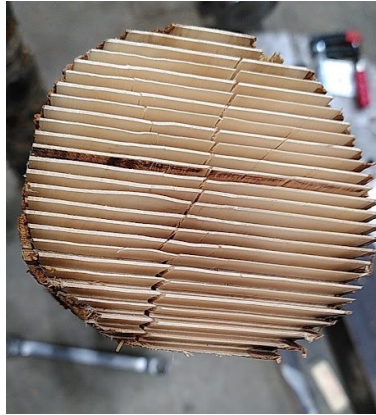
FIGURE 8.5 – Ondulations des entures du billon B7-I.
