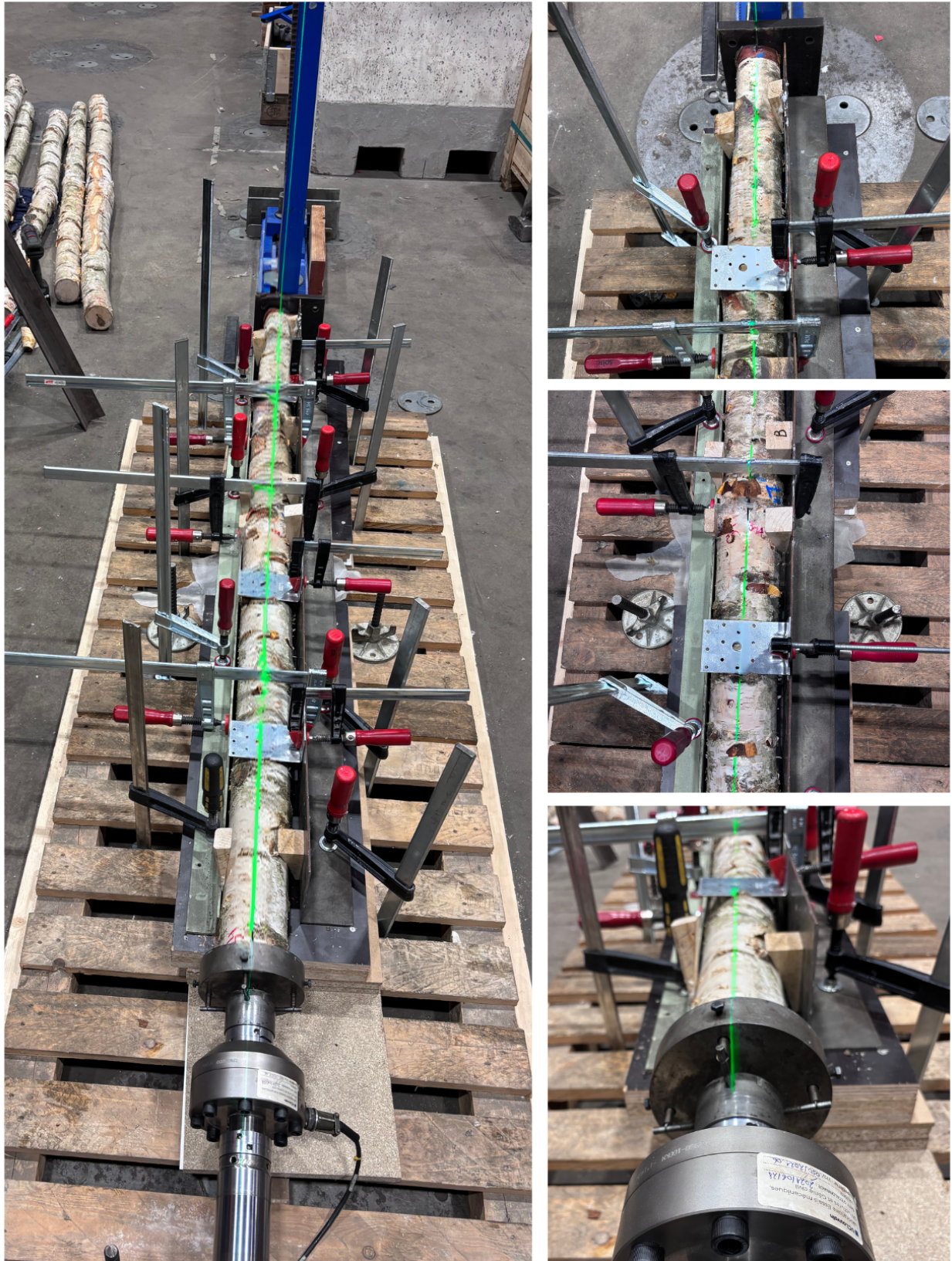
FIGURE 10.4 – Dispositif de serrage - Alignement des billons.
