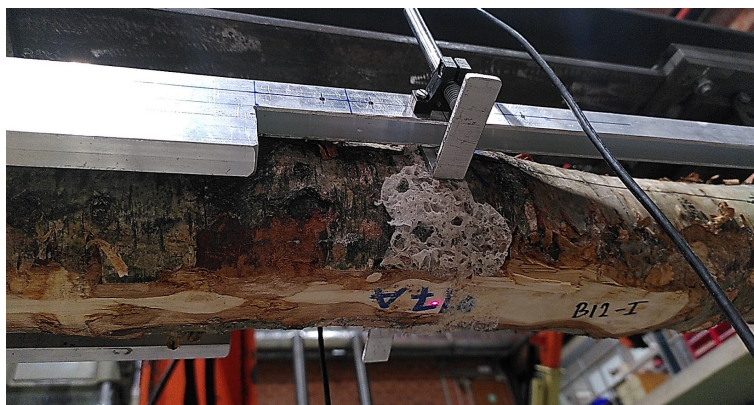
FIGURE 7.7 – Placement du laser pour la mesure de la flèche.
