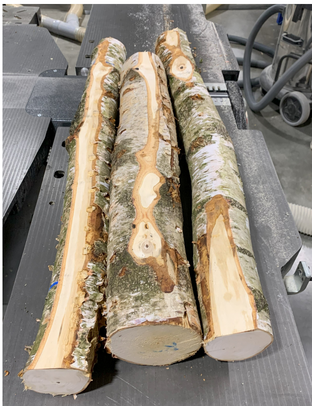
FIGURE 7.2 – Dégauchissement des billons avant l'aboutage.
