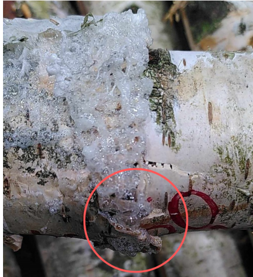
FIGURE 11.12 – Déformations au niveau de l'aboutage de l'essai IV.9 suite au serrage.
