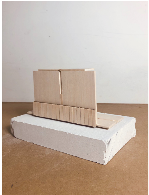
Photos de maquettes représentant le détail technique de deux modules empilés et accolés ©Ducci P.
