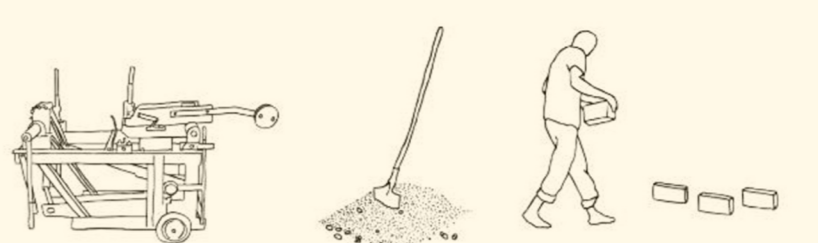
Presse utilisée pour la fabrication et briques séchant au soleil
