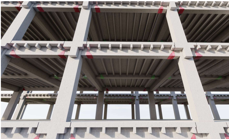
Fig. 31 - Vue perspective du modèle 3D des dalles assemblées aux arcs de colonnes
