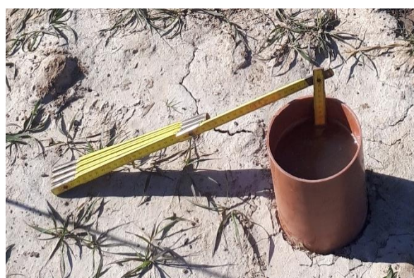
Figure 10 : Photographie de la méthode de mesure d'infiltration inspirée d'Ariane Chabert.
