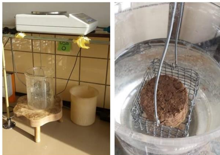
Figure 15 : Photographies du dispositif du Quanti-Slake Test.
