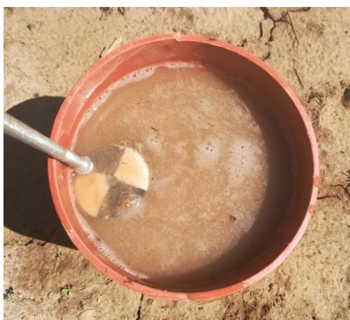
Figure 17 : Mesure de la turbidité de l'eau à partir d'un disque de Secchi par la méthode Ariane Chabert.
