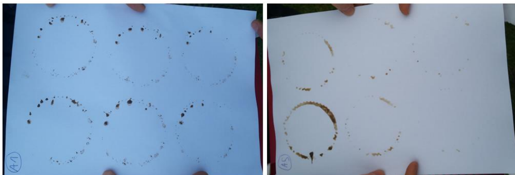
Figure 18 : Test maison de mesure de la stabilité des agrégats. Photographies des marques laissées sur du papier par une bouteille en verre de 75 cL après l'avoir posée sur le sol.
