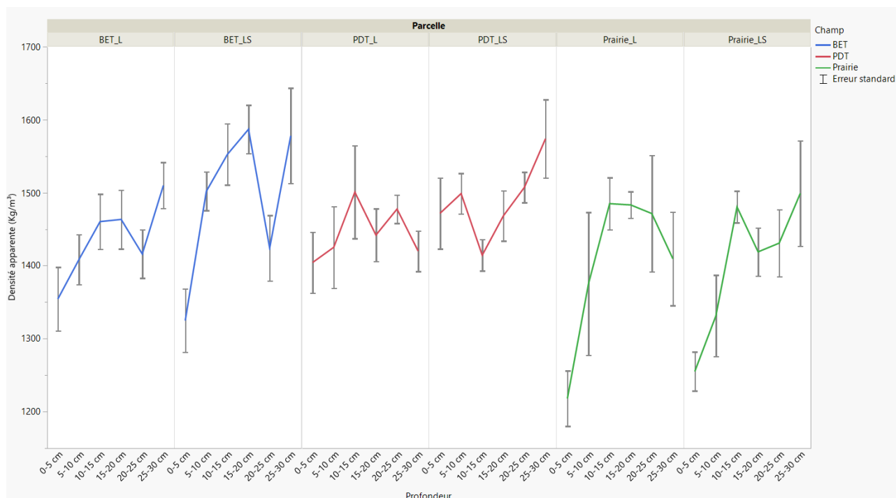
Figure 23 : Moyennes et erreurs standards des mesures de densité apparente du sol en fonction de la profondeur pour chaque parcelle. BET : champ de betterave. PDT : champ de pommes de terre. Prairie : Prairie permanente. X_LS : champ X de texture limono-sableuse. X_L : champ X de texture limoneuse.
