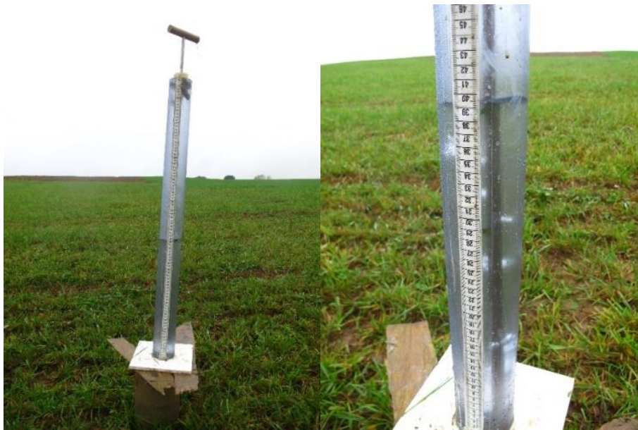
Annexe 12: Photos de l'infiltromètre
