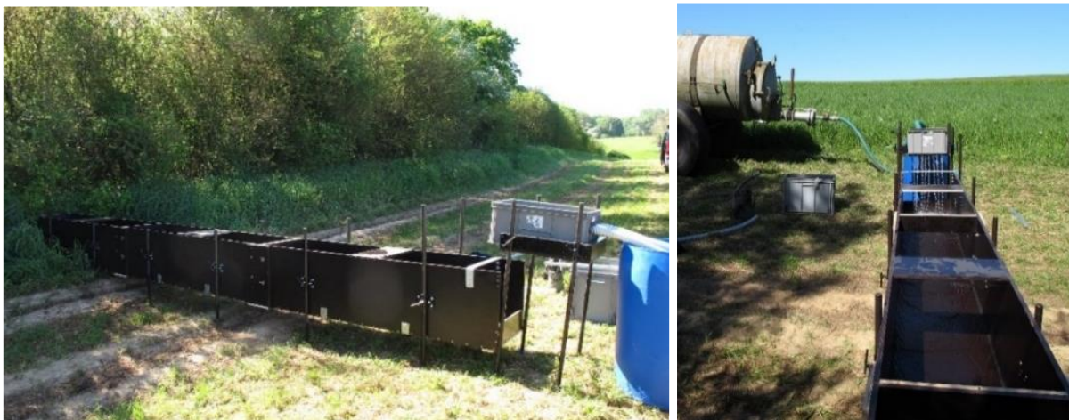
Figure 20 : Photos du simulateur de ruissellement et de sédimentation
