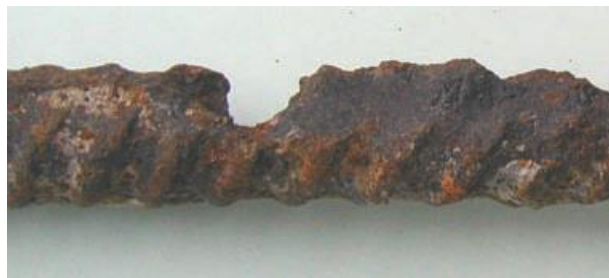
Figure 16: Piqûres de corrosion dues aux chlorures [17]
