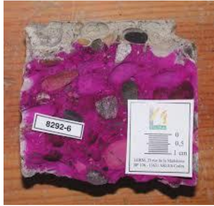
Figure 15: Fracture de béton aspergé de phénolphtaléine [8]
