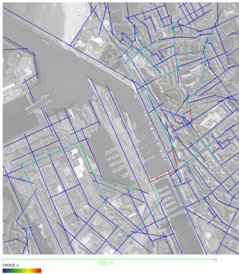
ANALYSE SPACE SYNTAX Analyse par Segments | Choix
