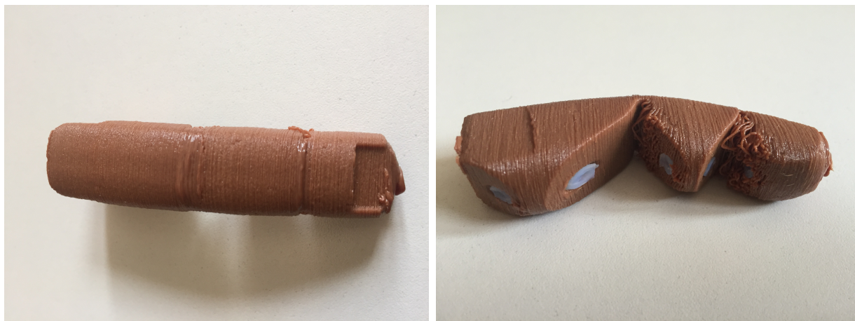
FIGURE 3.13 – Deuxième doigt imprimé (raft détaché, et tubes téflon-PTFE insérés)
