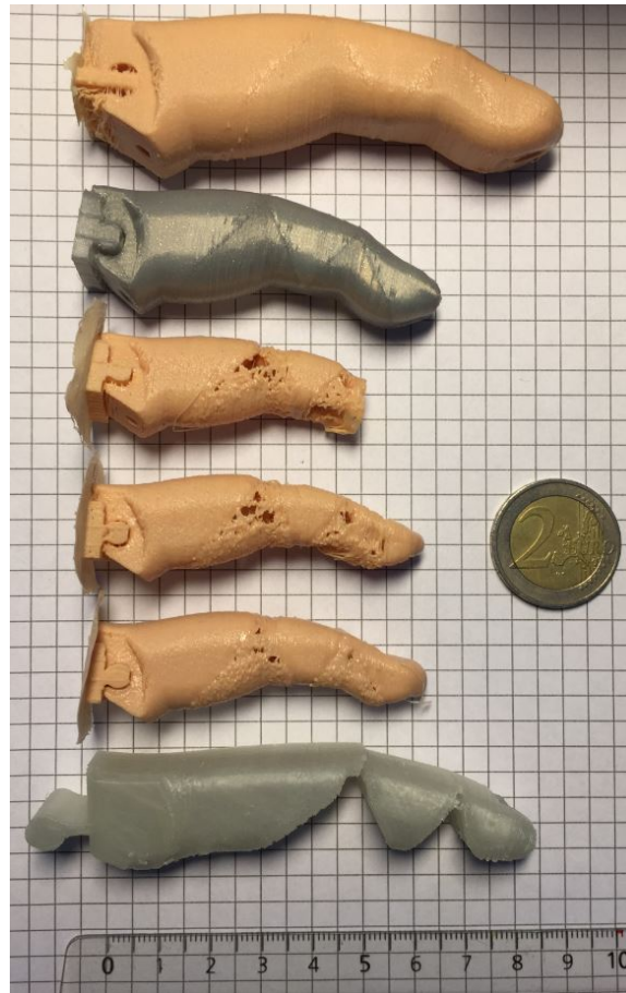
FIGURE 3.7 – Modèles de doigt de la Flexy Hand Remix et modèle imprimé en PLA
