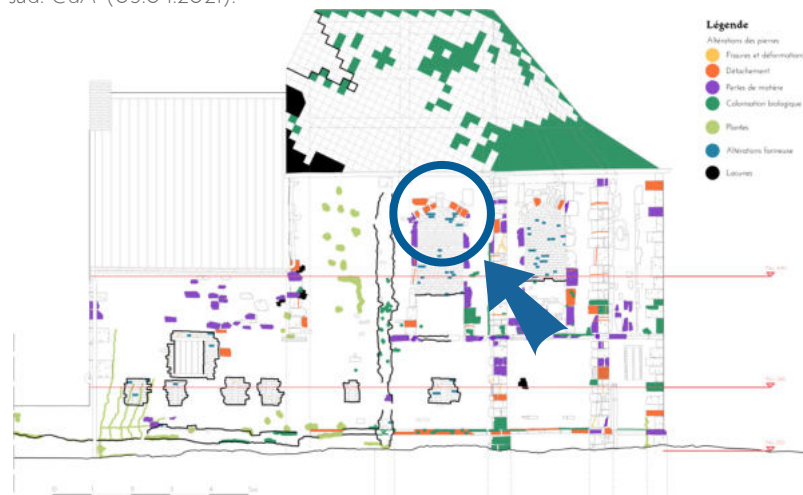
Fig. 126 Pulvérulence du tuffeau. 1 ère baie gothique sud. CdA (03.04.2021).
