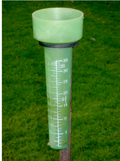
FIGURE 2.1 – Exemple d'un pluviomètre à lecture directe [6]
