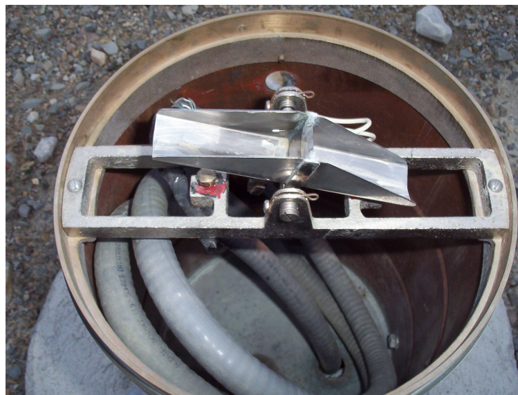
FIGURE 2.2 – Exemple d'un pluviomètre à auget basculeur [7]
