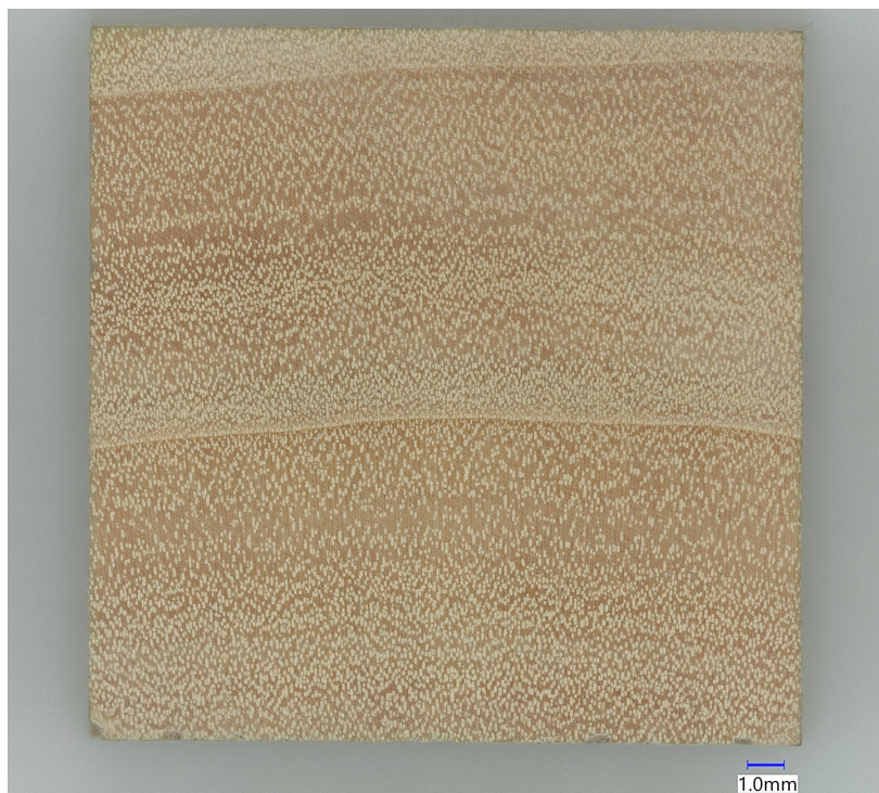
FIGURE 3.1 – Observation microscopique de la section d'un échantillon brut
