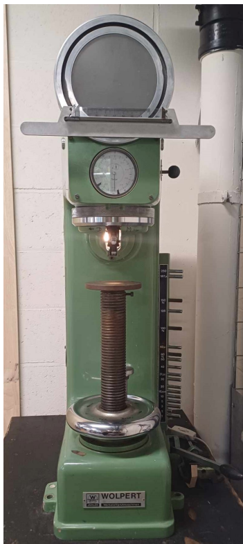
FIGURE 2.9 – Machine d’essai de dureté Dia Testor 2 RC (gauche) et présentation schématique du pénétrateur Brinell et de la forme d’une empreinte (droite) [5]
