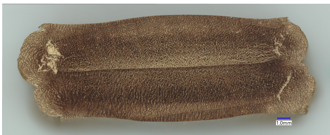
FIGURE 3.2 – Observation microscopique de la section d'un échantillon densifié à 140 °C
