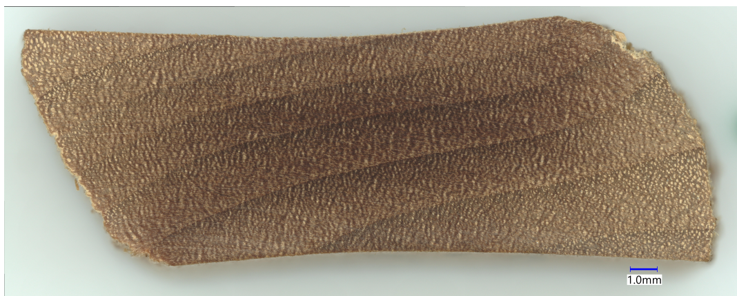
FIGURE 3.21 – Observation microscopique de la section d'un échantillon prétraité à 65%H et densifié à 170 °C
