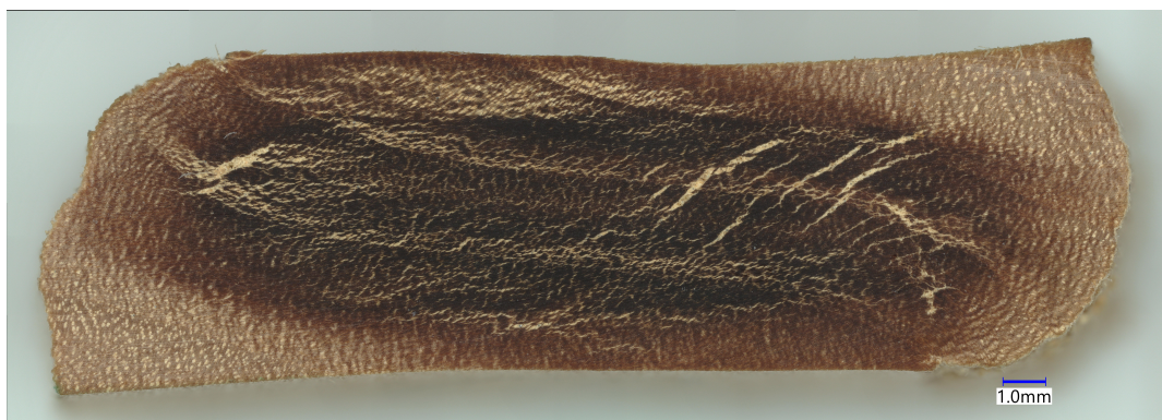
FIGURE 3.3 – Observation microscopique de la section d'un échantillon densifié à 170 °C
