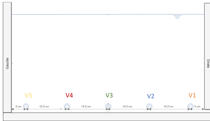
Figure 4-31: Configuration des mesures de vitesses à 2cm du fond du sas
