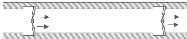
Figure 1-6: Remplissage par les portes [3]
