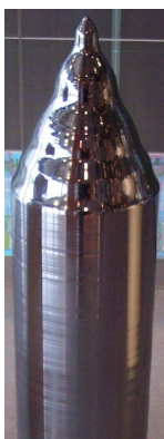
FIGURE 1.11 – Lingot de silicium monocristallin obtenu par le procédé de Czochralski 3
