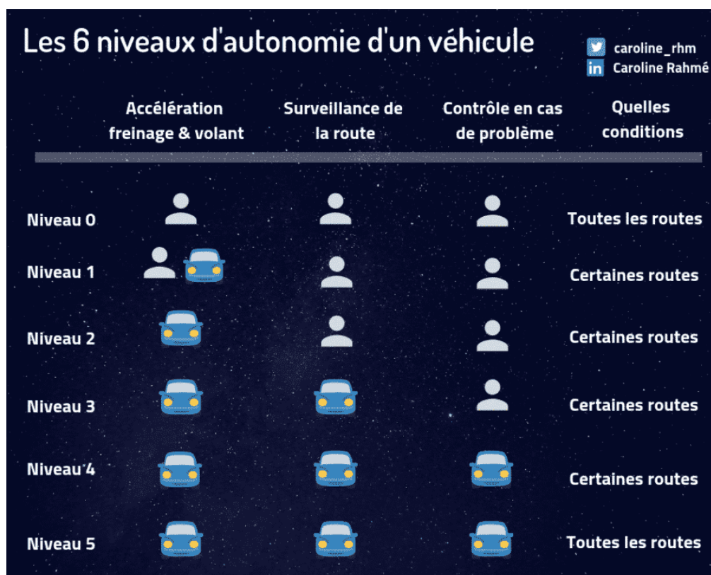
Figure 1 - Les niveaux d'autonomie des véhicules autonomes (Rahmé, 2019)
