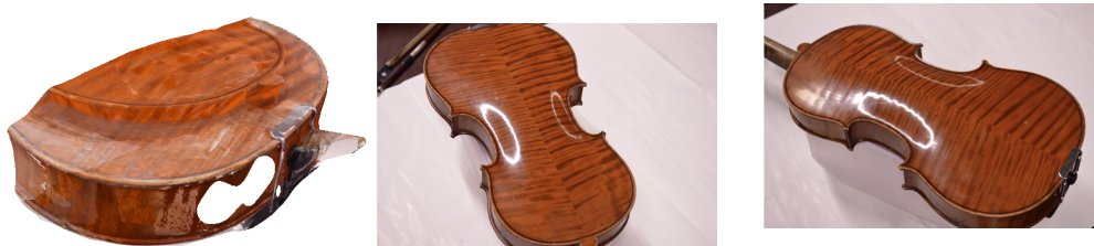
FIGURE 82 – Exemple de maillage loupé à cause du brillant
