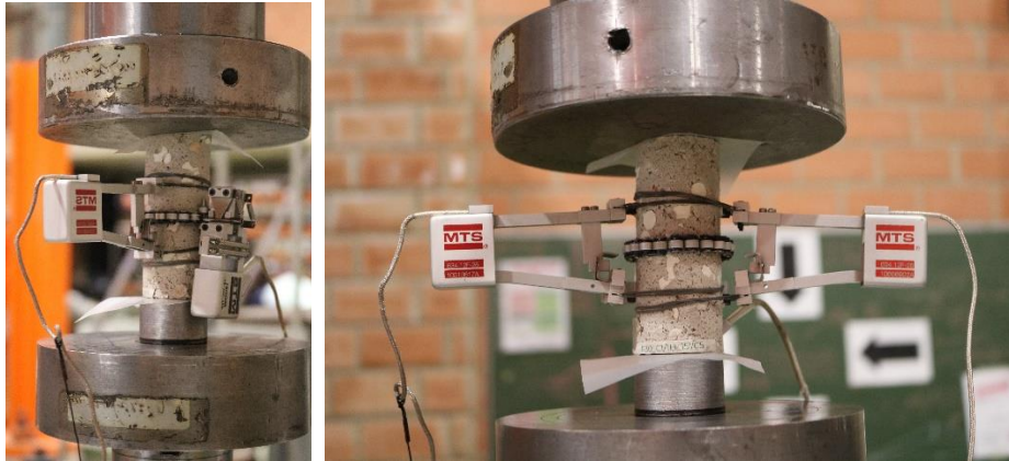
Figure 2.3-7 : Essais de compression
