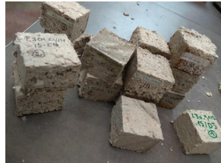
Figure 2.4-6 : Echantillons découpés pour l'essai thermique
