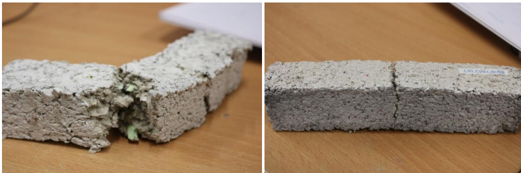
Figure 4.1-12 : Photos des échantillons après l'essai de flexion
