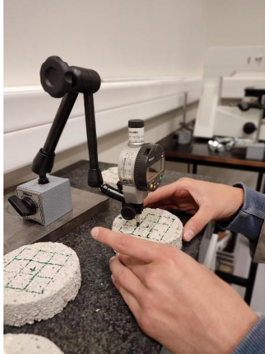
Figure 2.3-9 : Mesure de la hauteur des points avec le comparateur
