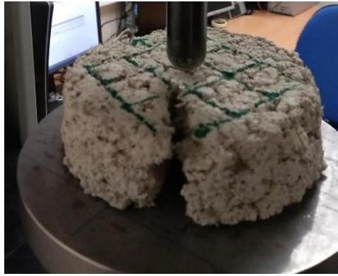
Figure 3.4-4 : échantillon M30-C1-1H-15-D20 fissuré lors du poinçonnement
