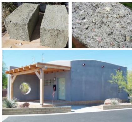
Figure 1.2-6 : A. Brique en papercrete, B. Papercrete, C. Torchis de papercrete [20]
